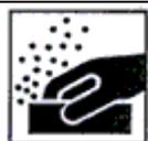
Après avoir poncé, appliquer sur des primaires epoxy, plusieurs couches de mastic jusqu'à obtenir l'épaisseur voulue. Entre chaque couche poncer et souffler avec de l'air propre et sec. Recouvrir avec des produits epoxy ou polyurethanes. Pour avoir une bonne adhérence, tous les mastics doivent être poncés à l'abrasif à sec, avant d'être recouvert.
